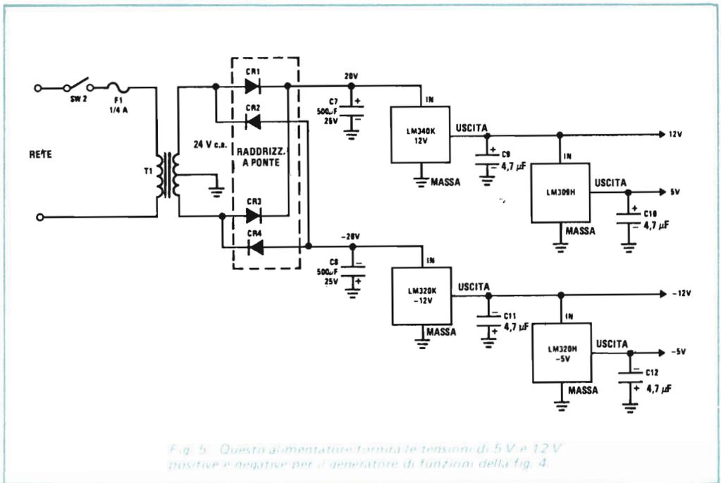
*Fig. 5. Questo alimentatore fornisce le tensioni di 5 V e 12 V positive e negative per il generatore di funzioni della fig. 4.*
