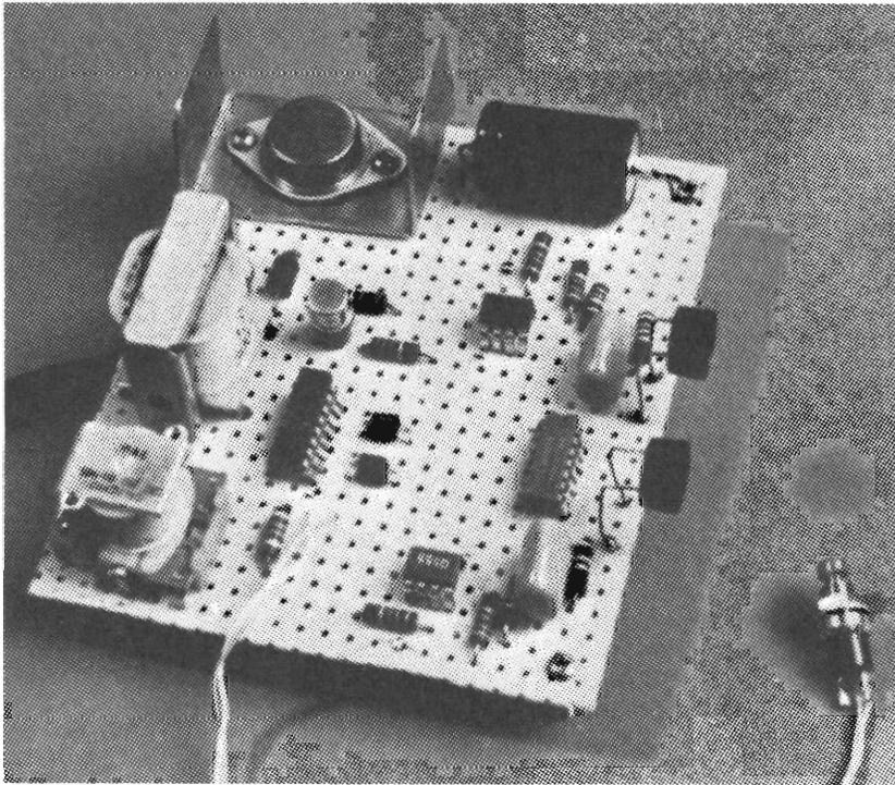
*Fig. 4 - Il prototipo del sistema fotoelettrico è stato montato interamente su una basetta perforata, a destra della quale si trovano i LDR. L'interruttore di chiarificazione è collegato mediante fili intrecciati.*
