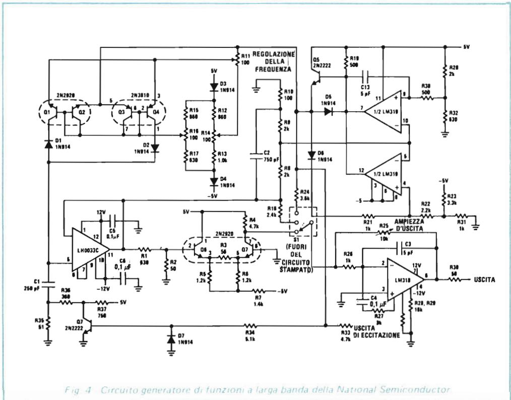
Fig. 4 - Circuito generatore di funzioni a larga banda della National Semiconductor
