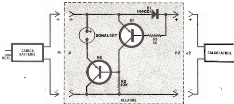
Fig. 1 - Quando la corrente tampone attraverso D1 cessa, il Sonalert viene azionato.
