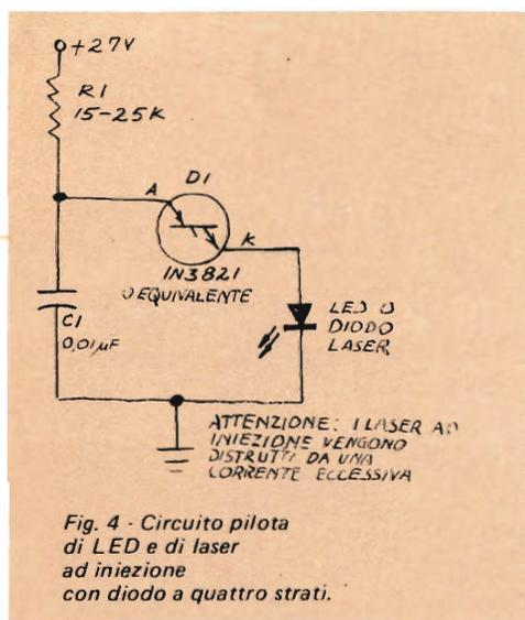
Fig. 4 - Circuito pilota di LED e di laser ad iniezione con diodo a quattro strati.
