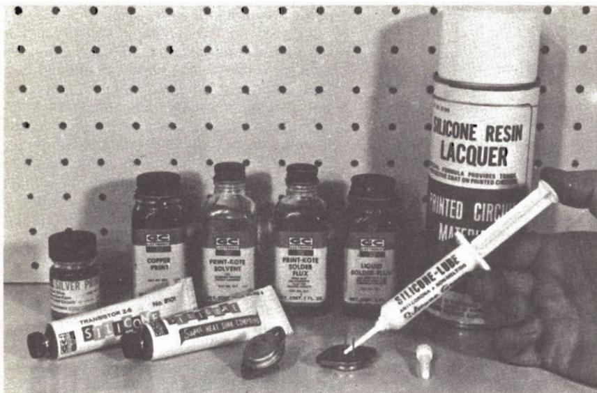
*Le sostanze chimiche per la manutenzione dei circuiti stampati comprendono composti con grasso al silicone per disperdere il calore, vernici conduttrici, lacche a base di resine al silicone per la protezione dei circuiti, e solventi.*
