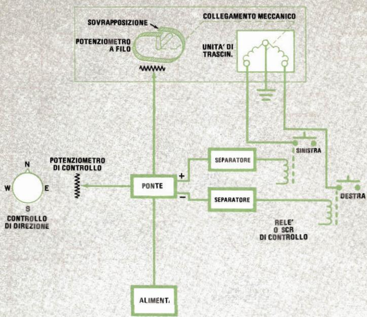
**ROTATORE AUTOMATICO A CONTROLLO ELETTRONICO**
